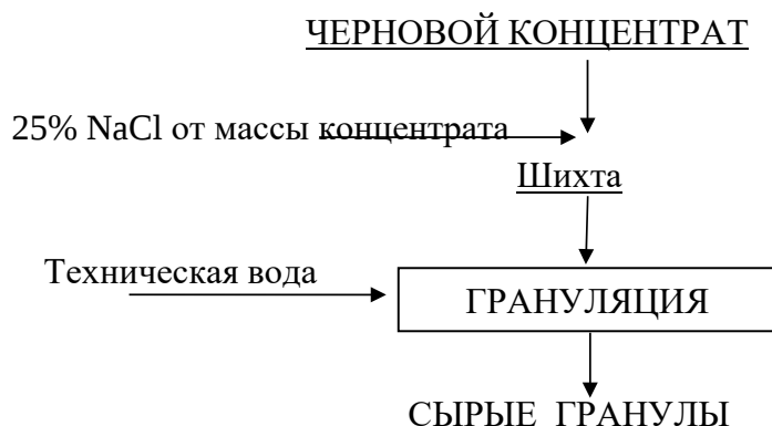
Рисунок 12 – Технологическая схема грануляции черного концентрата
