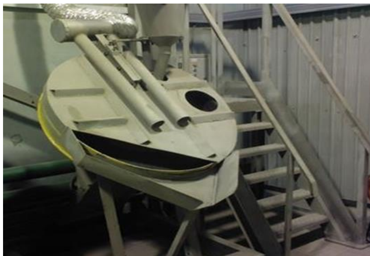
Рисунок 14 – Укрупненно – лабораторный гранулятор
